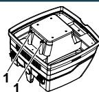
Регулярно очищайте датчик уровня воды (1) и проверяйте на наличие повреждений.
