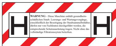
Sauger der Staubklasse H sind geeignet für das Auf-/Absaugen von trockenen, nicht brennbaren Stäuben, krebserzeugenden und krankheitserregenden Partikeln sowie nicht brennbaren Flüssigkeiten, Holzstäuben und gesundheitsgefährlichen Stäuben mit AGWs < 0,1 mg/m<sup>3</sup>.
