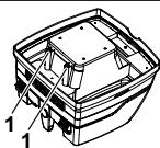
De waterpeilsensoren (1) regelmatig reinigen en onderzoeken op tekenen van beschadiging.
