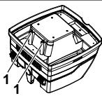
Regularnie czyścić czujniki poziomu wody (1) i sprawdzać pod kątem widocznych uszkodzeń.
