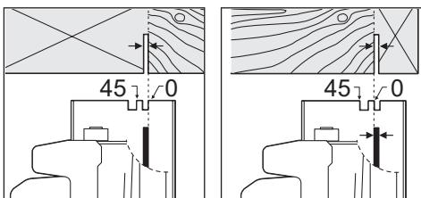
Le marquage de coupe  $0^\circ$  **9** indique la position de la lame de scie lors d'une coupe à angle droit. Le marquage de coupe  $45^\circ$  **8** indique la position de la lame de scie lors d'une coupe à  $45^\circ$ .
