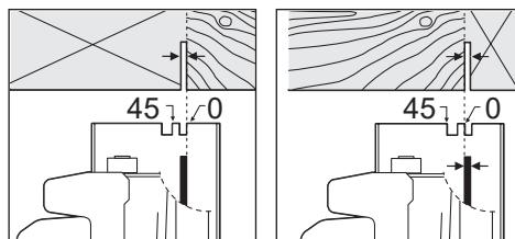
La marca de posición  $0^\circ$  **9** indica la posición de la hoja de sierra al efectuar cortes perpendiculares. La marca de posición  $45^\circ$  **8** indica la posición de la hoja de sierra al efectuar cortes a  $45^\circ$ .
