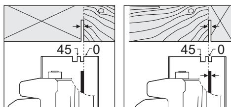
Wskaźnik cięcia 0° **9** ukazuje ustawienie tarczy przy cięciu pod kątem prostym. Wskaźnik cięcia pod kątem 45° **8** ukazuje pozycję tarczy przy cięciu pod kątem 45°. Dla wykonania precyzyjnego cięcia należy przyłożyć pilarkę do elementu obrabianego tak, jak pokazano na rysunku. Najlepsze efekty osiągnie się, jeżeli przeprowadzi się uprzednio cięcie próbne.
