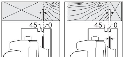
A marcação de corte de  $0^\circ$  **9** indica a posição da lâmina de serra para cortes perpendiculares. A marcação de corte de  $45^\circ$  **8** indica a posição da lâmina de corte para cortes de  $45^\circ$ .
