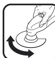
Tramite l'azionamento oscillante, l'elettrotensile oscilla fino a 21000 volte al minuto per 2,8°. Questo consente lavori precisi in uno spazio ristretto.
