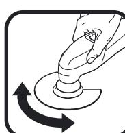
Un accionamiento oscilante hace que el útil efectúe un movimiento de vaivén de 2,8° hasta 21000 veces por minuto. Esto permite trabajar de forma precisa en un espacio muy restringido.
