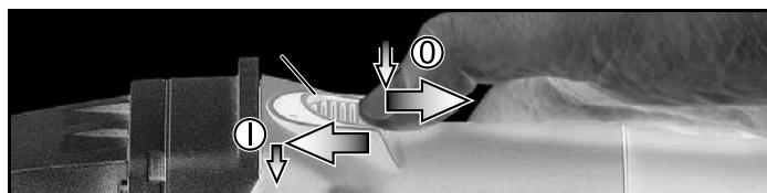
**Conección/Funcionamiento constante:** desplace el relé neumático (1) hacia adelante. Para un funcionamiento continuado, moverlo hacia abajo, hasta que encaje.
