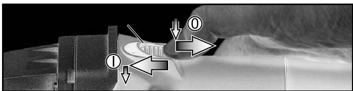
**Marche/fonctionnement en continu:** Pousser l'interrupteur coulissant (1). Pour un fonctionnement en continu, le basculer vers l'arrière jusqu'au cran.
