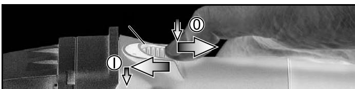
**Collegamento/Funzionamento costante:** scorra il relè pneumatico (1) verso avanti. Per un funzionamento continuato, muoverlo verso il basso, fino a che si incastri.
