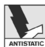
Emme kanalı 5 anti statik malzemeden yapılmadır. Ek olarak bir kullanılacak olan anti statik emme hortumu (aksesuar) zımparalamaya sırasında ender olarak ortaya çıkabilecek aletin elektro statik yüklenmesini önerler.
